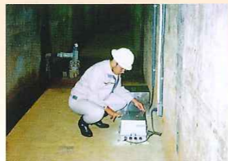
地震によるダムへの影響がないか調べるため、ダムの中でも地震の大きさを測ることができます。
