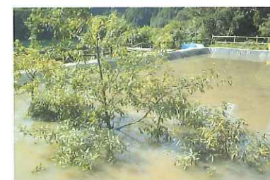
大きなプールを作り丸山ダムの湖岸に多く生育している樹種を水没させることで試験湛水や出水時の水没によって樹木が受ける影響を調べます。
