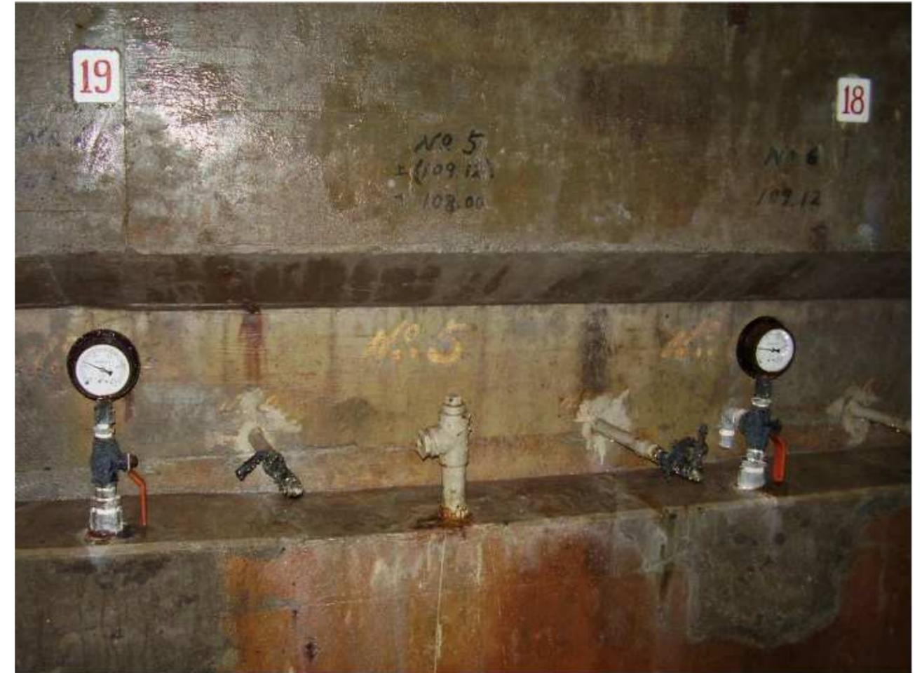
写真－ 1.3.1 揚圧力計の設置状況
