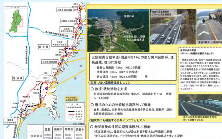
◇三陸縦貫自動車道（津波を考慮して高台に計画された高速道路）
