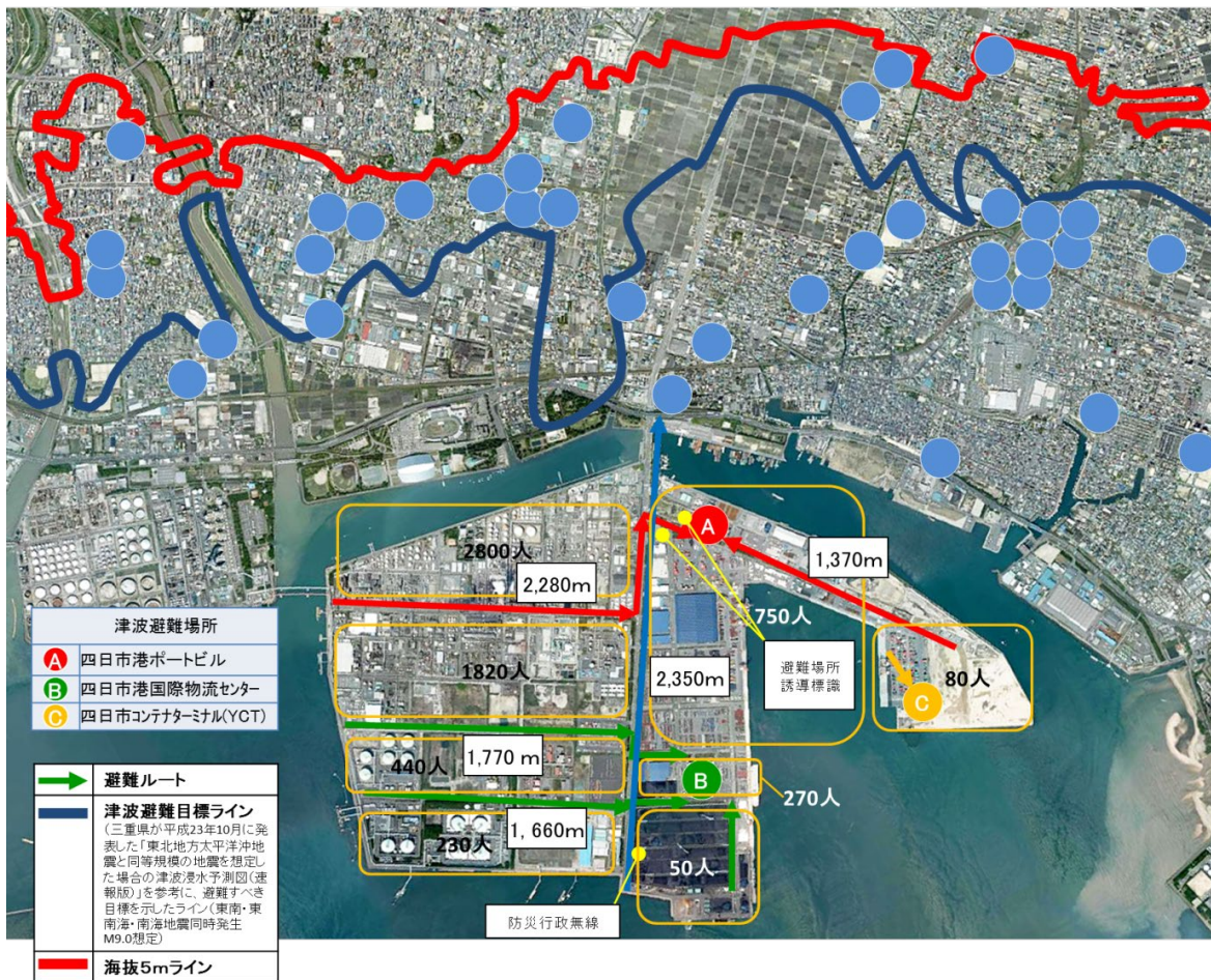
◇港湾の堤外地における避難誘導計画 (四日市港霞ヶ浦地区)
