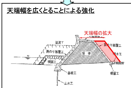
◇海岸堤防の津波対策（粘り強い堤防）
