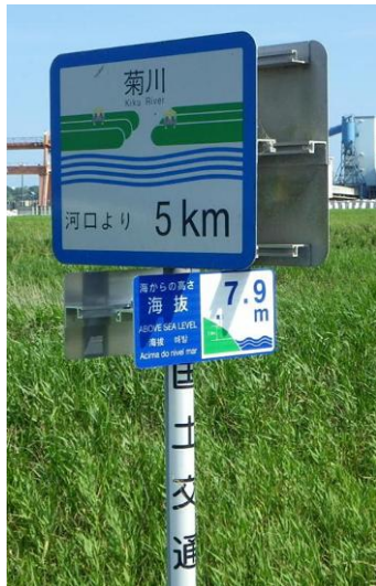
◇河川堤防距離標への海拔表示
