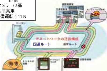
国道の伝送路を活用した光ネットワークのダブルネット化
