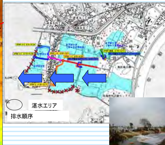
宮城県東松島市東名地区での排水事例
