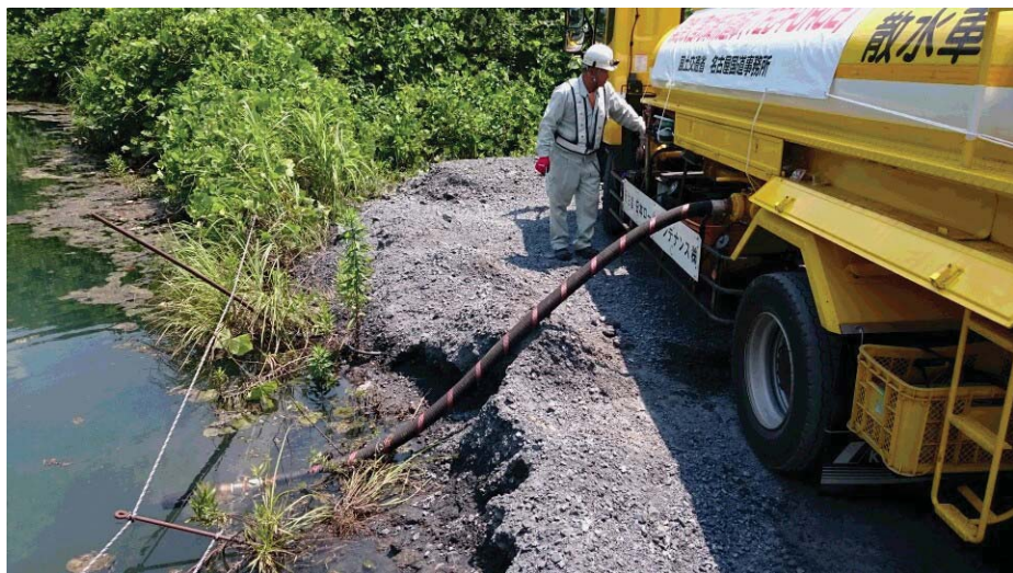
給水中の散水車
