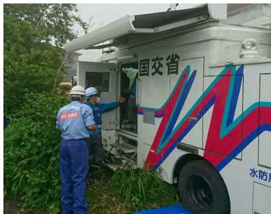
衛星通信車による映像配信の確認
