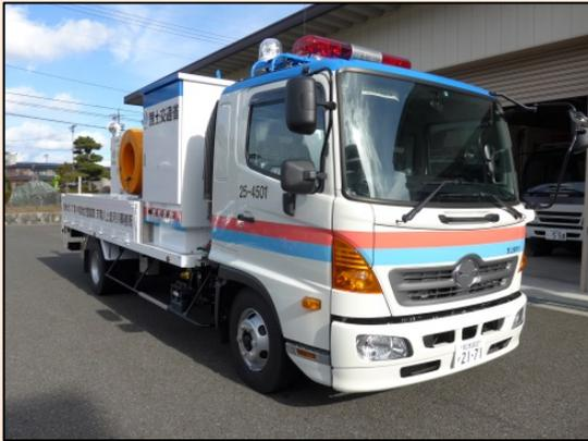
水中ポンプ、発電機、ホースを1台の車両に搭載して、浸水被害箇所において、1台で排水作業が可能となります。
