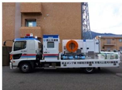
排水ポンプ車は、発電機と排水ポンプ、ホースなどを搭載し、浸水被害現場へ出動し、1台で排水作業をすばやく行なえる車両です。
