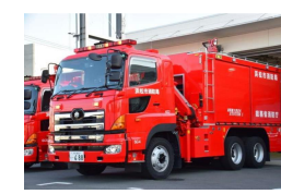
海水利用型消防水利システム（スーパーポンパー）
