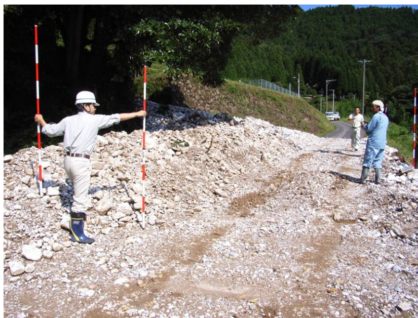
流出した土砂量の調査状況 （9月4日撮影）
