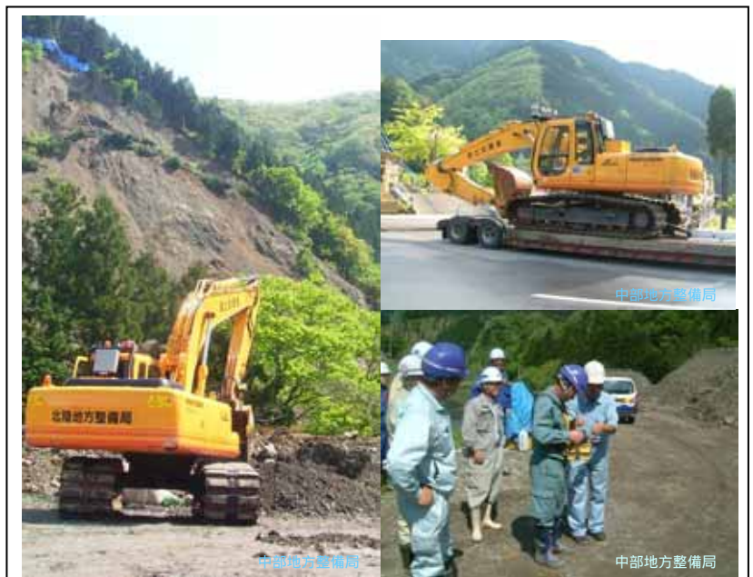
遠隔操縦式バックホウ(北陸地方整備局)の 支援と操作訓練
