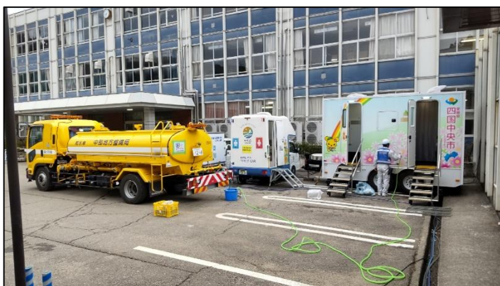
トイレトレーラーに水中ポンプで給水(河原田小学校)
