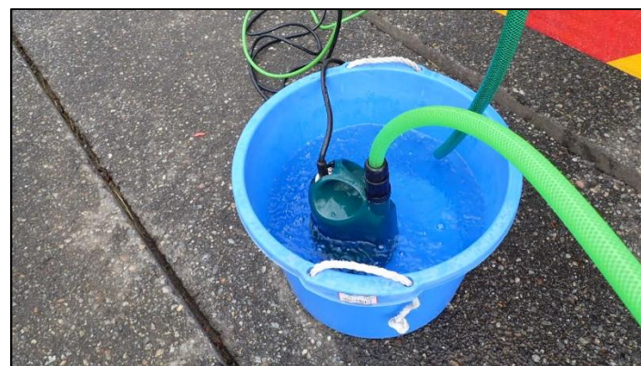
トイレトレーラーに水中ポンプで給水(河原田小学校)
