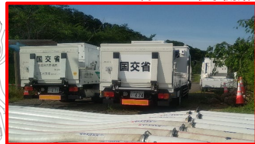
※排水ポンプ車④(ポンプ4台) 設置準備中
