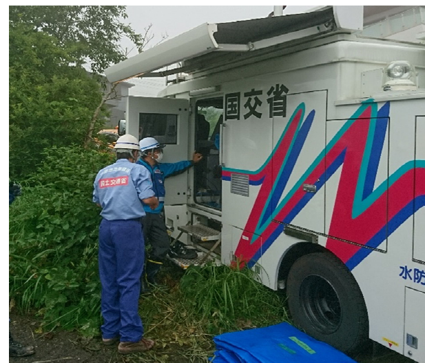
衛星通信車による映像配信の確認
