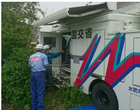
衛星通信車による映像配信の確認
