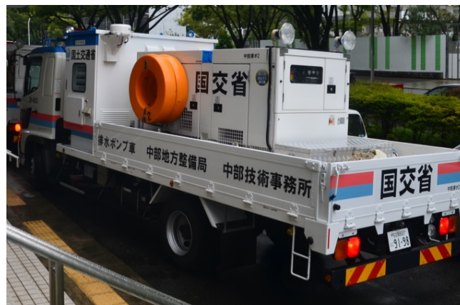
派遣される排水ポンプ車
