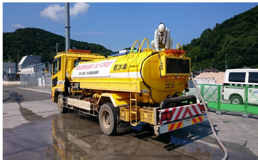
タンクへの生活水補給作業
