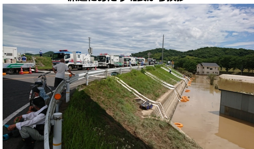
倉敷市にて活動を行う排水ポンプ車
