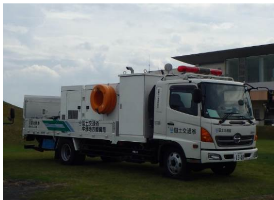
【排水ポンプ車】
