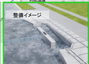
横断工作物改築と併せた縦断連続性の確保（三重河川国道事務所）
