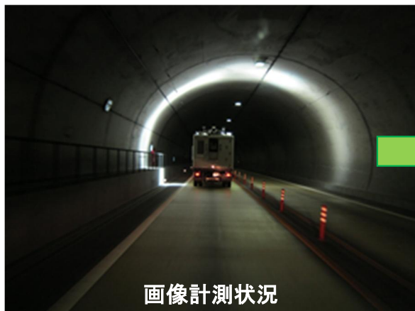
撮影画像からひび割れ等の変状を図化(熊野尾鷲道路 逢神曾根トンネル)
