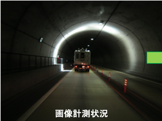
撮影画像からひび割れ等の変状を図化(熊野尾鷲道路 逢神首根トンネル)
