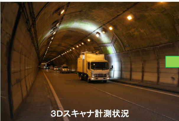
3Dレーザースキャナによる断面変形の把握(国道41号 大原山トンネル)
