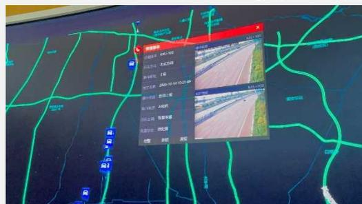
停止車両の自動検知
