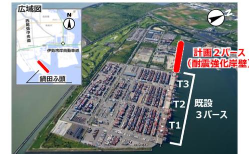
近海航路のコンテナ貨物量の増加に対応するため、新たなコンテナターミナル（2バース）を整備する計画が予定。また、耐震強化岸壁とすることで震災時のコンテナ輸送を確保。
