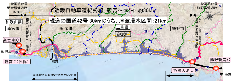
図5 津波浸水区域を通過する国道42号
