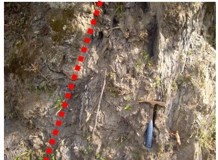
中央構造線部(粘土化している)
