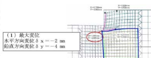
図-4-Ⅲ-28 用地制約のある地盤改良の変形
