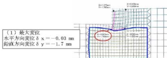
図-4-Ⅲ-27 30° 分散角の地盤改良の変形
