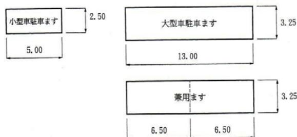
参図-4 大型車、小型車の駐車ます寸法（単位：m）
