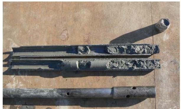
写真-2-I-1 標準貫入試験用サンプラー
