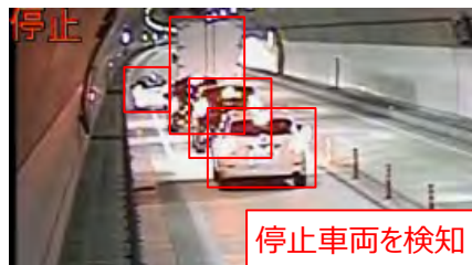
検知イメージ(トンネル内)
