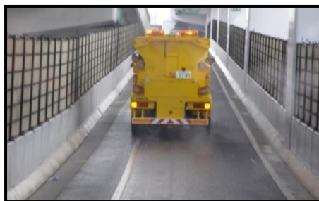
溶液散布の状況（ランプ部）
