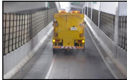
溶液散布の状況（ランプ部）
