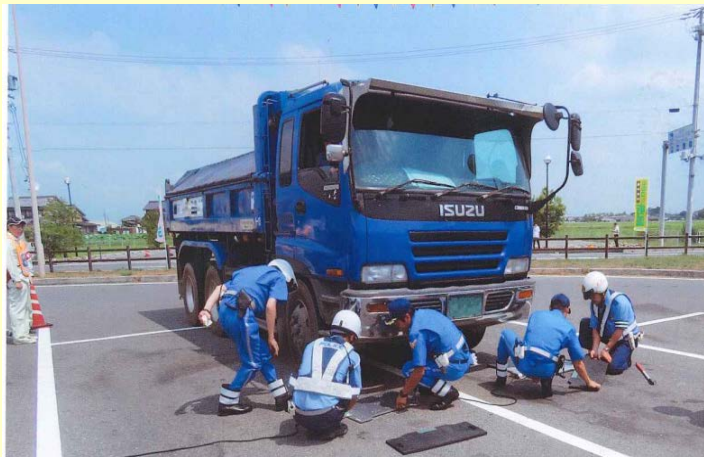
過積載車両に対する計測の状況
