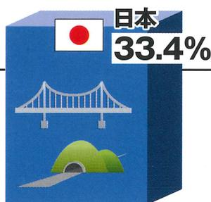
構造物比率※ =  $\frac{\text{橋の長さ} + \text{トンネルの長さ}}{\text{道路全体の長さ}}$  ※道路全体の長さの内、橋やトンネルなどの構造物の長さの割合
