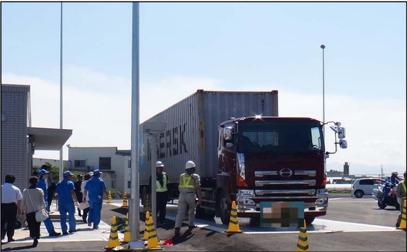
国際海上コンテナの取締状況 (許可値34.69tのところ実測38.9t 徐行の措置命令発出)
