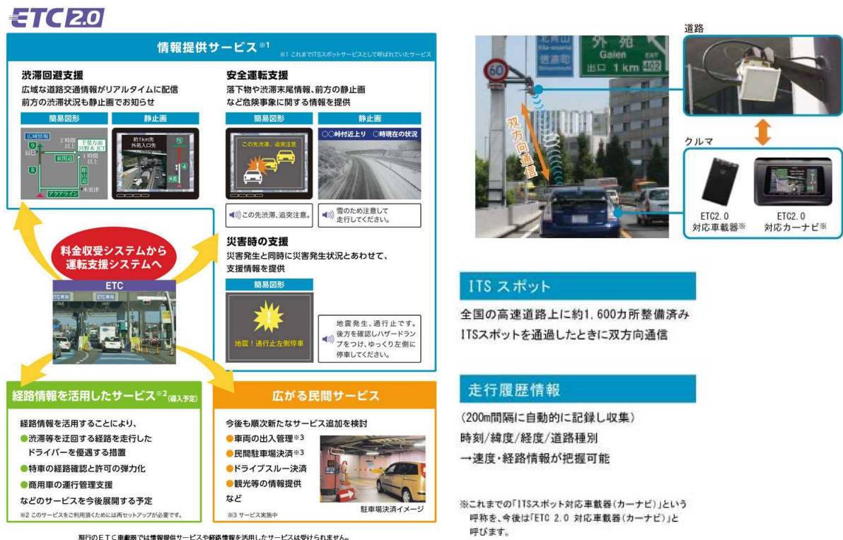
図表- 144 ETC2.0・運転支援システムの提供サービス概要
