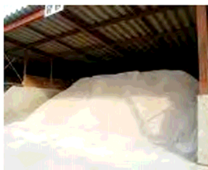
生コン工場にシェルサンドを搬入し、シェルコンクリートを製造する
