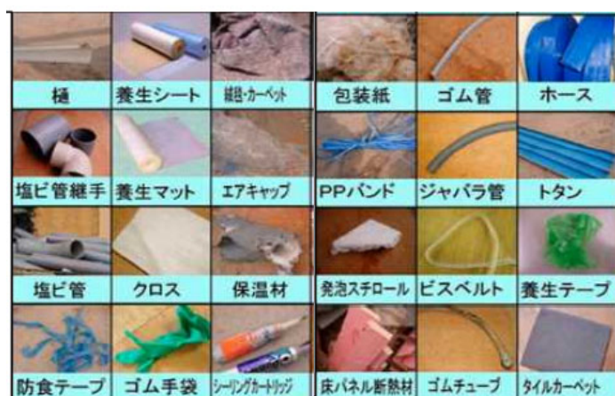
図15 建設現場で発生する廃プラスチック品目の具体例
