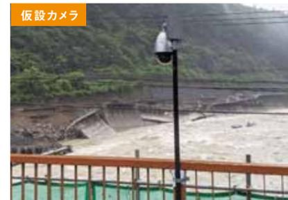
災害現場等に仮設監視カメラを設置します。特に災害復旧工事等の現場において二次災害発生の恐れのある箇所などに設置し現地状況の把握に用いられます。
