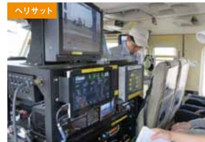
防災ヘリコプターに搭載されたヘリサット(ヘリコプター搭載衛星通信システム)により、災害等が発生した際に上空からのリアルタイム映像を地上へ伝送します。
