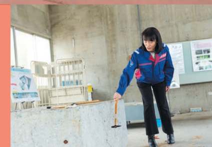
センター内に保管されている、劣化した橋梁の部材。点検ハンマーで叩いた時の音の高低差などで損傷の有無を確認でき、講習などに活用。
