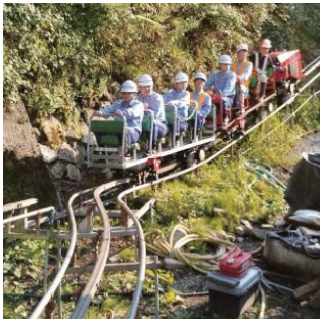
落石対策現場へモノレールで移動する様子
