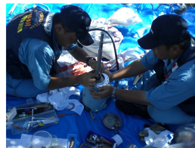
現地でのポンプ分解整備状況
