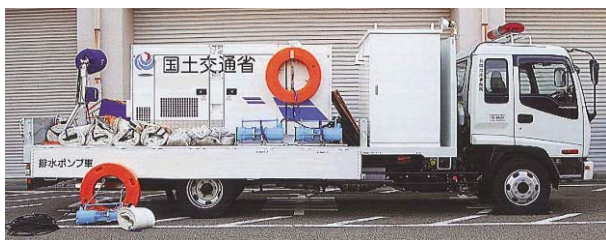
派遣する排水ポンプ車(イメージ)
