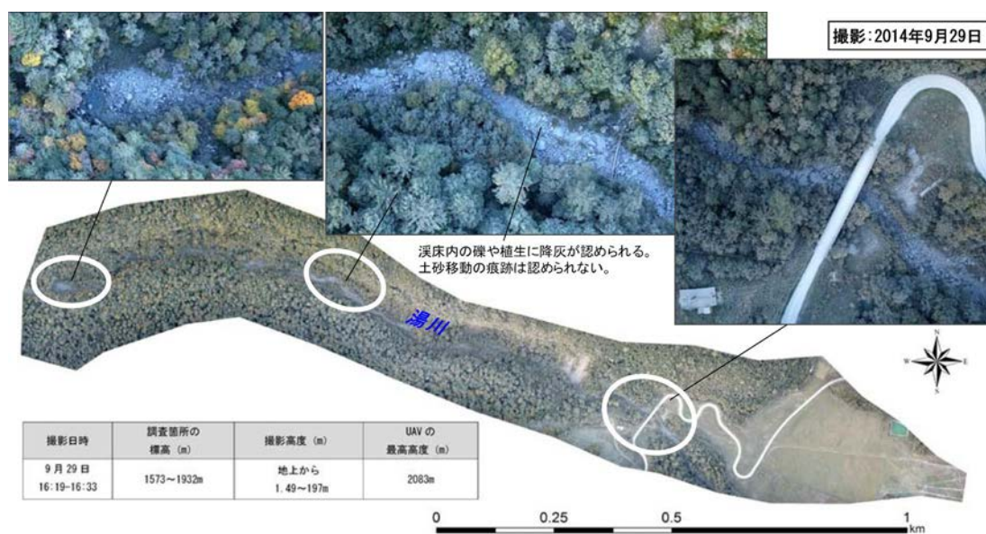
図 5.12.3 御嶽山噴火直後に実施したドローンによる降灰状況調査例
