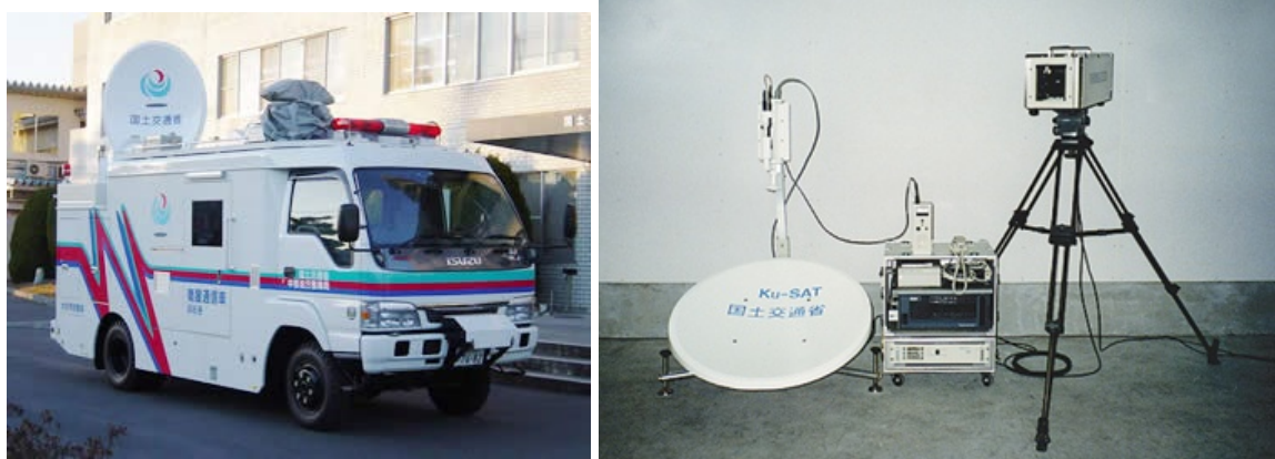
図 4.6.1 国土交通省が保有する衛星通信車K-COSMOS（左）とKu-SAT（右）
