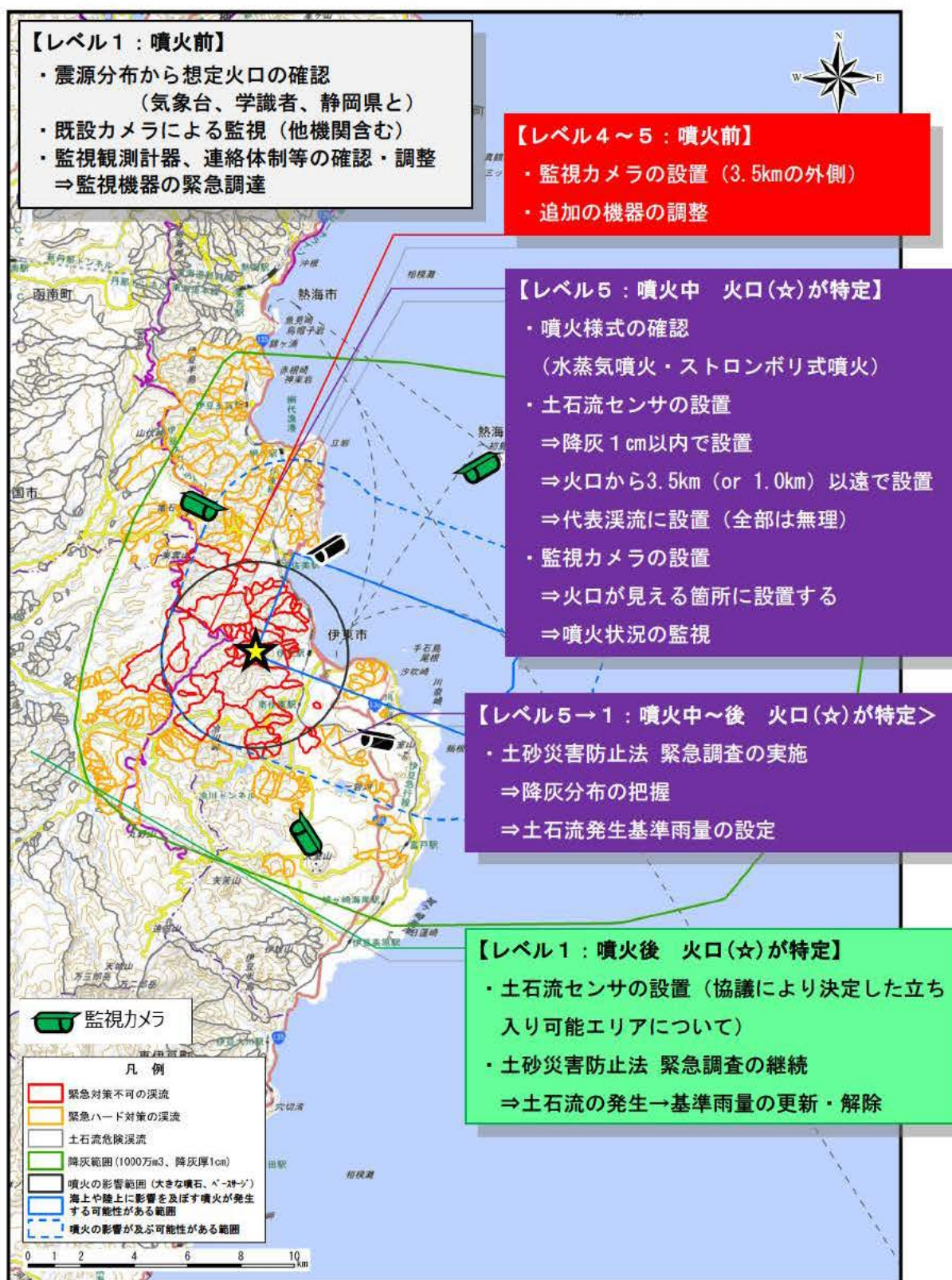
図 4.8.2 緊急ソフト対策の方針イメージ (想定火口が南西端の場合)
