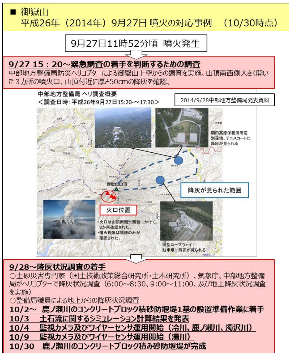
図 2.2.3 噴火時の緊急調査の対応事例（平成26年（2014年）御嶽山噴火）
