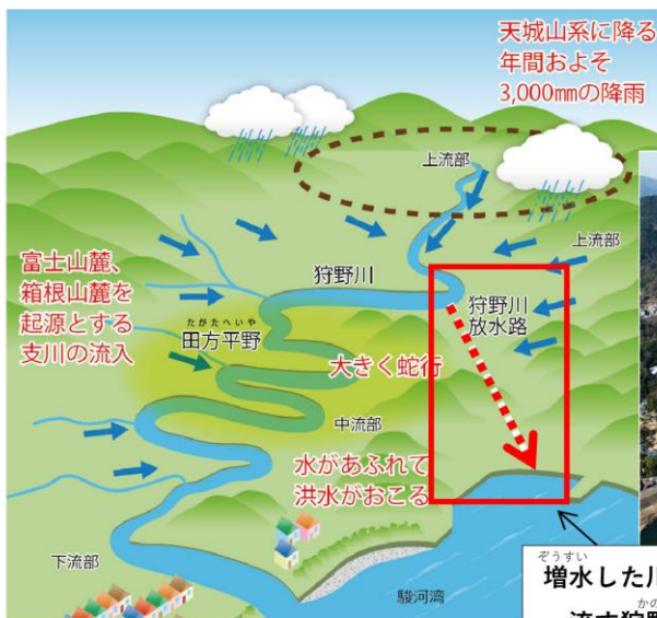
狩野川と狩野川放水路
