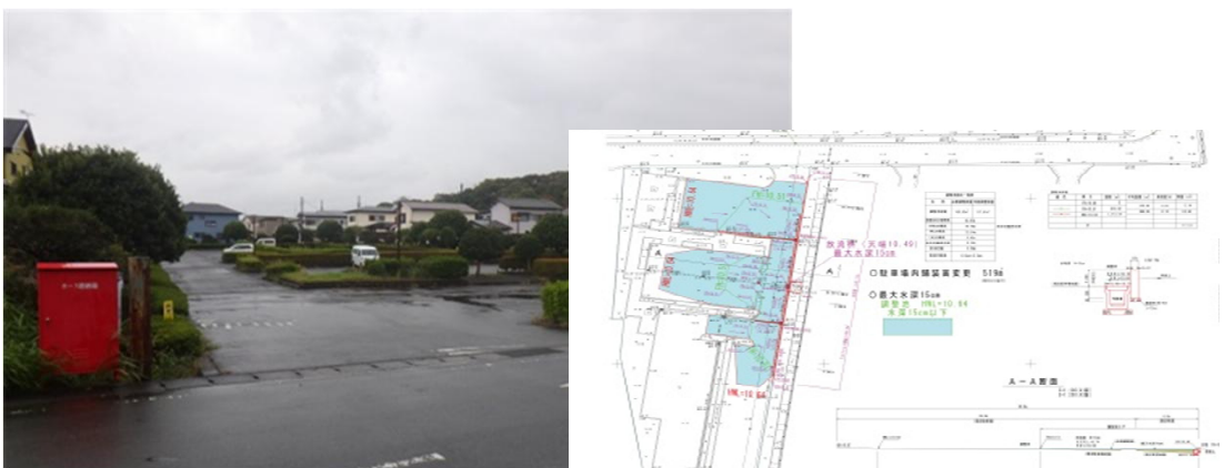
町営公園駐車場への雨水貯留施設新設
