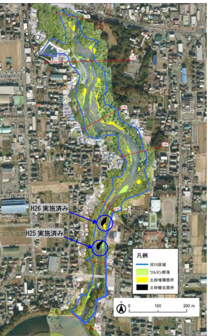
図 5-6 堆積土砂の撤去及びツルヨシの駆除に係る整備箇所
