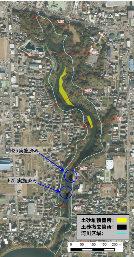
図 5-6 堆積土砂の撤去及びツルヨシの駆除に係る整備箇所
